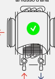
Connessione con la stessa direzione del flusso d'aria
