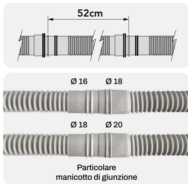
Il tubo, realizzato in coestrusione, permette una maggiore resistenza agli agenti atmosferici ed all'acqua di condensa. I nuovi materiali utilizzati, unitamente alla nuova geometria della corrugazione, garantiscono elevata flessibilità e resistenza meccanica rendendolo ideale per applicazioni sotto traccia o in canalina.
