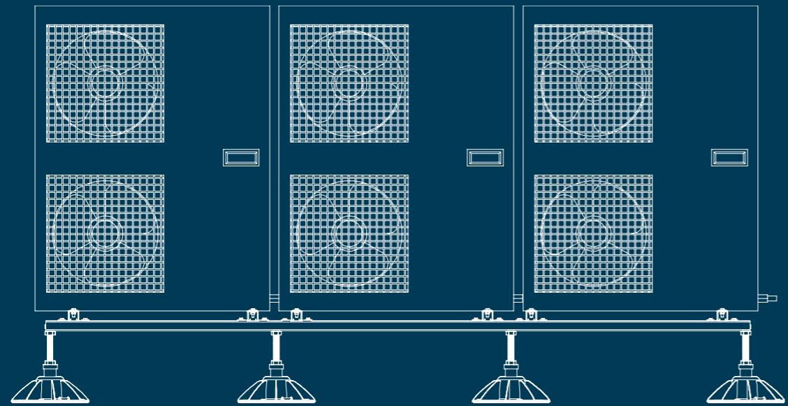
I sistemi Hercules e Genius Modular sono progettati per offrire una **soluzione versatile e affidabile per supportare le unità VRV / VRF e gruppi frigoriferi**, garantendo una corretta installazione e un'efficienza ottimale del sistema. Grazie al suo design modulare, il sistema può essere facilmente adattato alle diverse configurazioni e alle esigenze specifiche del progetto.
